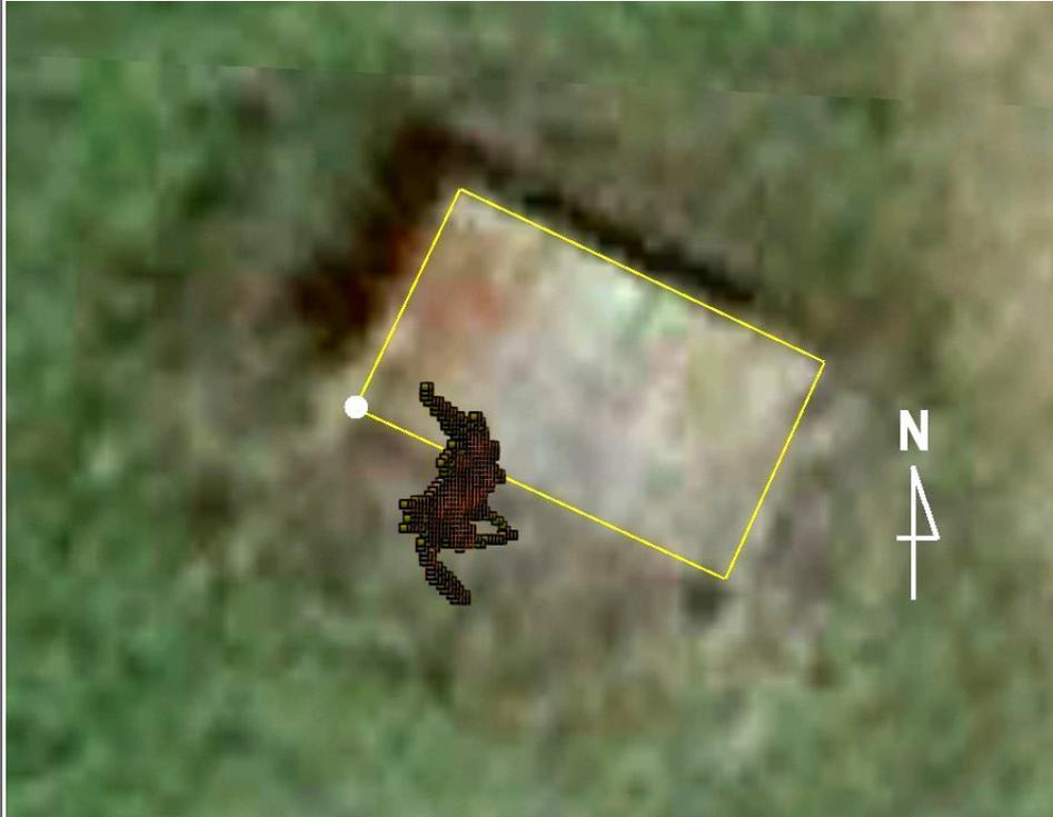
A sinistra: Fig. 1 - Rosa di misure della stazione fissa temporanea in GR. Il rettangolo indica il perimetro della copertura dello scavo e il pallino bianco il punto vero (sfondo Google-earth®).
